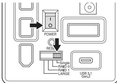
電源がOFFの状態で、モード切替スイッチをSingleの位置に合わせ電源をONにし、PC上でHDDが2台認識されているかを確認してください。
