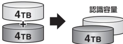
4TBのHDDを2台使用すると4TBのHDD1台のボリュームとして認識される。
