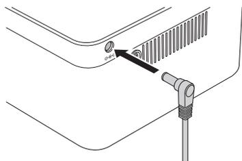
本体の電源コネクタに専用 AC アダプターを接続します。
