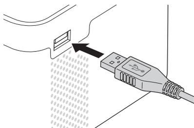
USB ケーブルの USB プラグを本製品の USB コネクタに接続します。
