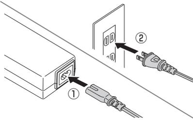
専用 AC アダプターに専用 AC ケーブルを接続し①、コンセントに接続します②。
