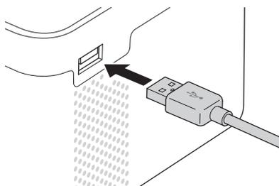
Dock ケーブルの USB プラグを本製品の USB コネクタに接続します。
