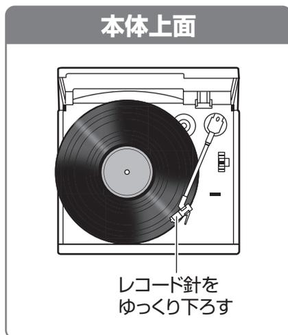
6. レコードの再生が終了したら、トーンアームを持ち上げながらアームレストへ戻し、トーンアーム固定フックで固定してください。
