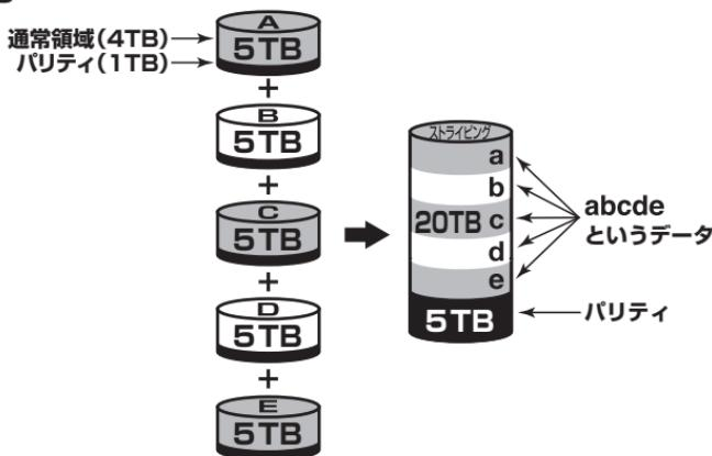
5TBのHDDを5台使用すると20TBのボリュームとして認識される。
