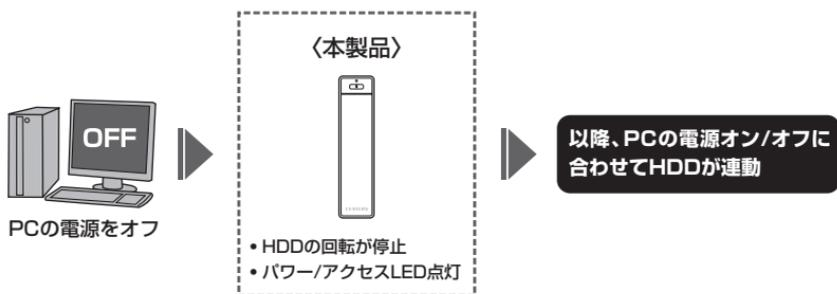
※HDDの抜き差しを行う際は、PC電源連動機能でHDDの回転がオフになった状態ではなく、必ず**電源スイッチで電源を切ったオフの状態(パワー/アクセスLED消灯)**で行ってください。HDDの回転がオフになっただけでは、まだ電源はオンの状態ですので、この状態でHDDの抜き差しを行うと、データが消失、または破損する可能性があります。
