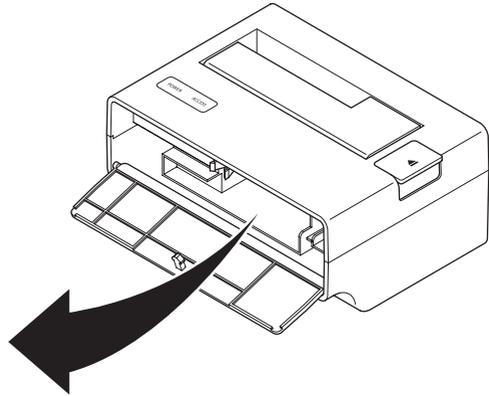
2: 本体 IDE 接続コネクタの保護カバーを取り外し、IDE データケーブルと IDE 電源ケーブルを図のように差し込みます。
