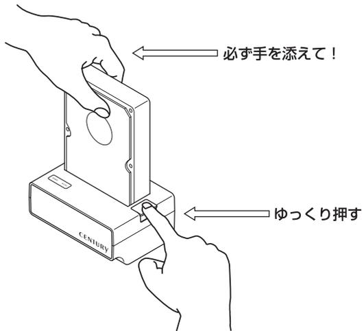
2 : ボタンを押すと、HDD がせり出していきますのでゆっくりと垂直に HDD を取り外します。
