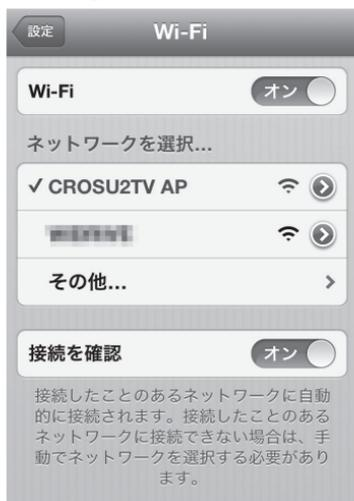
スマートフォンのWi-Fi設定を行います。お持ちのスマートフォンのWi-Fi設定画面を開き、Wi-Fiを有効にして「CROSU2TV AP」を選択すると、本製品とスマートフォンが1対1で接続されます。
