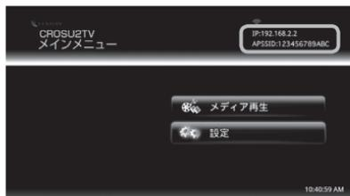
メインメニューに戻り、画面右上に無線LANのIPアドレスとSSIDが表示されていれば、本製品側の設定は完了です。
