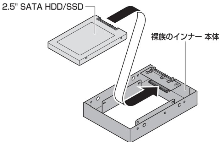
2. 付属のHDD固定用ミリネジで、本体とHDD/SSDを左右から4箇所ネジ止めします。
