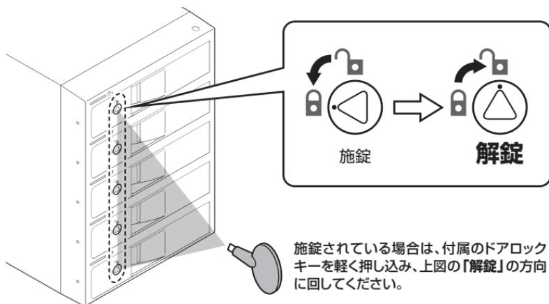
施錠されている場合は、付属のドアロックキーを軽く押し込み、上図の「解錠」の方向に回してください。
