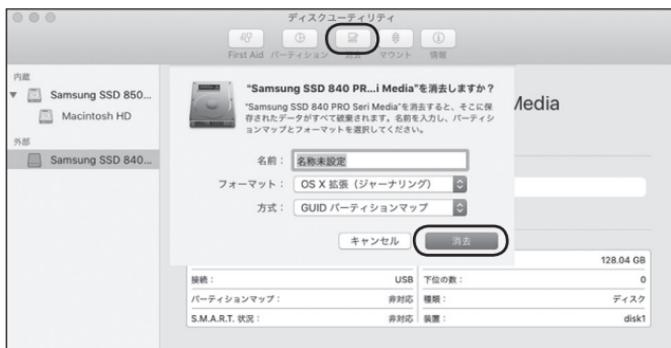
① ウィンドウ上部にある「消去」ボタンをクリックすると、シートダイアログが表示されますので設定を確認します。
