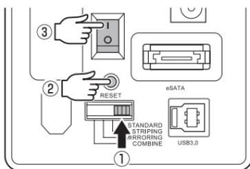
電源がOFFの状態で、モード切替スイッチを「STANDARD」の位置に合わせ(①)、モード切替スイッチを押しながら(②)、電源をONにします(③)。
