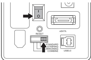
電源がOFFの状態で、モード切替スイッチを設定したいモードの位置に合わせます。
