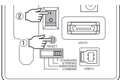
ボールペンの先や細い棒などを使ってモード変更ボタンを押しながら(①)、電源スイッチをONにします(②)。
