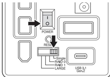
電源がOFFの状態、モード切替スイッチをSingleの位置に合わせ電源をONにし、PC上でHDDが2台認識されているかを確認してください。
