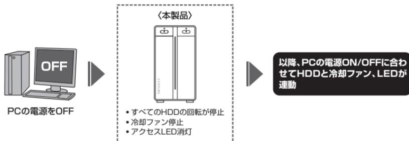
※HDDの抜き差しを行う際は、必ず電源スイッチをOFFにしてから行ってください。
