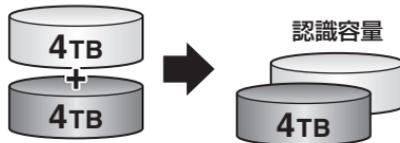
4TBのHDDを2台使用すると4TBのHDD 1台のボリュームとして認識される。
