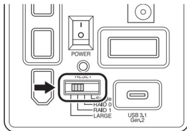
PC上で認識している状態で、モード切替スイッチを設定したいモードの位置に合わせます。
