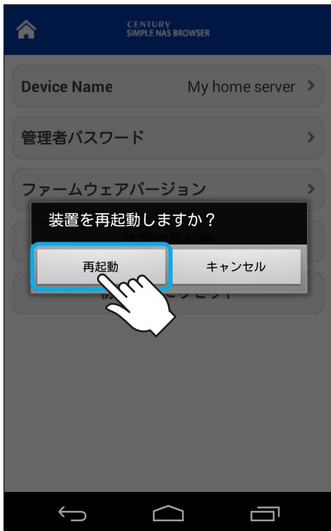
2. 「再起動」をタッチすると、「装置を再起動しますか?」と確認画面が表示されるので、再起動する場合は「再起動」をタッチします。
