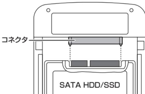
HDD/SSDをコネクタに半挿しした状態で通電すると、ディスクや基板が破損します。
