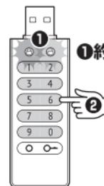
5桁以下、または16桁以上のパスワードを入力すると、両方のステータスLEDが交互に点滅後、緑色のLEDが点滅します。
