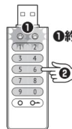
6桁以下、または15桁以上のパスワードを入力すると、両方のステータスLEDが交互に点滅後、緑色のLEDが点滅します。
