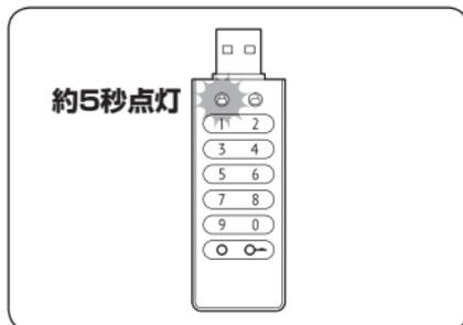
万が一、データ抹消機能が発動した際は、パスワードの再設定および、PC接続後、フォーマットを行うことで再度使用可能な状態になります。
