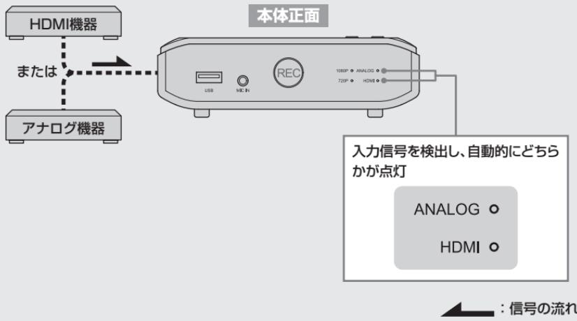
ANALOG/HDMIのどちらの機器も接続している場合、信号の到達が早い方が優先的に認識されます。表示を切り替える場合は、本体上面のANALOG/HDMI切り替えボタンを操作してください。
