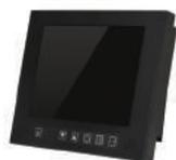
■産業用組み込み6.5インチ、640×480pixel(SVGA)モニター ■高寿命50,000時間のバックライトLED、耐久性に優れた金属製フレームを採用 ■表示鮮やかなグレアパネル仕様 コントラスト比600:1 ■ステレオスピーカー搭載/HDMI、VGA、DVI-Dの3系統入力に対応(HDCP非対応) ■壁掛用VESA(75×75)マウント準拠
