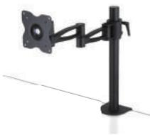
■VESA規格(75×75mm/100×100mm)対応の4軸式1面用モニターアーム ■モニターの向きが自由自在 微妙な調整も可能なフリーアングルアジャスター採用 ■モニターをしっかりと支え、ズレ落ちを防止するダブル調節レバー搭載 ■ダブルクランプ固定 ■耐荷重は最大12kg(推奨8kg) ■対応モニターサイズは27インチまで
