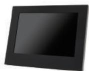
■産業用組み込み8.4インチ、800×600pixel(SVGA)モニター ■高寿命50,000時間のバックライトLED、耐久性に優れた金属製フレームを採用 ■広視野角、低反射ノングレア(非光沢)液晶パネルを採用、コントラスト比600:1 ■ステレオスピーカー搭載/HDMI、VGA、DVI-Dの3系統入力に対応(HDCP非対応) ■壁掛用VESA(75×75)マウント準拠
