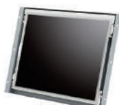
■組み込み用途向けオープンフレーム型12.1インチモニター ■解像度1,024x768(XGA) ■5線式抵抗膜方式タッチパネル採用(マルチタッチ非対応) ■高寿命50,000時間のバックライトLED ■耐久性に優れた金属製フレームを採用 ■低反射ノングレア液晶パネル採用 ■700:1のコントラスト比 ■HDMI、VGA、DVI-Dの3系統入力に対応(HDCP非対応) ■パネルマウントおよびVESA75/100に準拠 ※タッチパネル機能を使用しない場合は下記OS以外でも使用可能です
