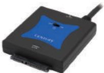
■SATA接続のHDDやSSD、光学ドライブを裸のまま簡単に接続 ■USBバスパワー駆動で電源不要※、めんどろな配線一切ナシ ■SATA6G、UASP対応で高速転送が可能 ※2.5インチHDD/SSDの場合、専用ACアダプターも付属しております。
