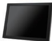
■産業用組み込み15インチ、1,024x768pixel(XGA)モニター ■高寿命50,000時間のバックライトLED、耐久性に優れた金属製フレームを採用 ■広視野角、低反射ノングレア(非光沢)液晶パネルを採用、コントラスト比700:1 ■ステレオスピーカー搭載/HDMI、VGA、DVI-Dの3系統入力に対応(HDCP非対応) ■壁掛用VESA(75x75)マウント準拠
