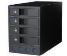
■HDD1台につき1ポートの独立インターフェイスを搭載し、PCとHDDを1対1で最大4台まで接続可能 ■付属のUSB変換アダプターとeSATAケーブルを使用して、USB接続またはeSATA接続が可能 ■1ドライブに1ポートなので、PCへの接続はWindows/Macの混在が可能 ■別売りの変換アダプター「裸族のインナー(CRIN2535)」(P.33)を使用することで、2.5インチSATA HDD/SSDの組み合わせにも対応
