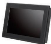
■組み込み用途向けパネルマウント型12.1インチモニター ■解像度1,280x800(WXGA) ■投影型静電容量方式タッチパネルによる10点マルチタッチに対応 ■高寿命50,000時間のバックライトLED ■6mm厚の削り出しアルミベゼルを採用 ■広視野角、低反射ノングレア液晶パネル採用 ■1000:1のコントラスト比 ■ステレオスピーカー搭載 ■HDMI、VGA、DVI-Dの3系統入力に対応(HDCP非対応) ■パネルマウントおよびVESA75に準拠 ※タッチパネル機能を使用しない場合は下記OS以外でも使用可能です
