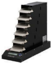
■これdo台Advanced (KD25/35AD1T5)のコピー/イレーズ速度を250MB/秒まで引き上げた、真のフラッグシップモデル ■SATA HDD/SSDの1:5同時コピーと6台同時イレーズが可能 ■6台フルに接続しても転送速度が低下しない完全プロ設計 ■本体を最大10台連続※して、1:59の同時コピー/60台同時消去が可能
