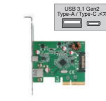
■PCI Express×4接続のUSB 3.1 Gen2 x2ポート搭載 (Type-A x1、Type-C x1)インターフェイスカード※1) ■Windows/MacOS両対応、MacOSはドライバレスで動作可能※2) ※1)USB 2.0/1.1デバイスはUSB 3.1の速度で動作しません。それぞれUSB 2.0/1.1動作となります。 ※2)Windows 7はドライバインストールのために光学ドライブまたはインターネット接続が必要となります。
