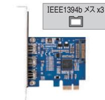
■PCI Express x1接続 IEEE1394b x3ポート インターフェイスカード ■信頼と実績のTexas Instruments (TI)社製コントローラ採用 ■ロープロファイルブラケット付属
