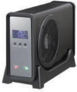
■静音性を高めた新大型8cmファンを搭載 ■HDDの監視温度設定によりファンの回転数が変化します ■HDDの温度とファンの回転数が一目でわかるLCDを搭載 ■設定した温度を超えるとアラームを鳴らすHDD温度監視機能搭載 ■接続状態がわかる2モードLED機能、電源を落としても設定を維持するメモリー機能を新搭載 ■別売りの変換アダプター「裸族のインナー(CRIN2535)」(P.33)を使用することで、2.5インチSATA HDD/SSDの組み込みにも対応
