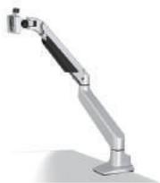
■3関節のスタイリッシュな液晶モニターアーム ■モニターの台座を必要としないので、デスクを広く使えます ■ガスシリンダー内蔵でスムーズな上下調節が可能 ■画面の角度を上下105°、左右180°に調節が可能。画面の傾き(チルト)も180°回転します ■前後位置の調節も自由自在。奥行きが広いデスクなどでの使用に最適です ■VESA規格(75x75mm、100x100mm)に準拠モニター耐荷重 2~10kg ■デスクへの設置は天板に取り付けるクランプタイプとスルーデスクタイプの2WAY方式 ■ケーブルをすっきり配線できるケーブルクリップ付き
