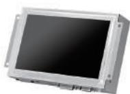
■組み込み用途向けオープンフレーム型7インチワイドモニター ■4線式抵抗膜方式タッチパネル採用 ■寿命50,000時間のバックライトLEDを採用 ■広視野角、低反射ノングレア液晶パネルを採用 ■解像度は800×480pixel(WVGA)で、1000:1の高コントラスト比 ■HDMI、VGA、DVI-Dの3系統入力に対応(HDCP非対応) ■耐久性に優れた金属製フレームを採用し壁掛用VESA(75×75)マウントに準拠
