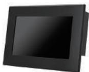
■組み込み用途向けパネルマウント型7インチワイドモニター ■4線式抵抗膜方式タッチパネル採用 ■6mm厚の削り出しアルミベゼル、耐久性に優れた金属製フレームを採用 ■寿命50,000時間のバックライトLEDを採用 ■広視野角、低反射ノングレア液晶パネルを採用 ■解像度は800×480pixel(WVGA)で、1000:1の高コントラスト比 ■HDMI、VGA、DVI-Dの3系統入力に対応(HDCP非対応)
