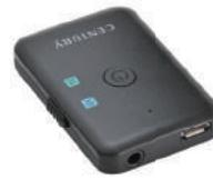
■音声の送信/受信を切り替えて使える、一台二役のBluetoothオーディオアダプター ■2台使用でBluetooth非対応のオーディオ機器どうしてもワイヤレス接続が可能 ■充電しながら使用可能
