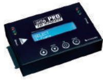
■最大転送速度250MB/秒のコピー&イレース ■「スピードテスト機能」と「S.M.A.R.T情報表示機能」を搭載 ■3種類のコピー機能&コピー支援機能搭載(まるごとコピー/システム&ファイルコピー/パーティションコピー/エラースキップ/コンペア) ■2台同時消去も可能な3種類のデータイレース機能搭載(クイックイレース/フルイレース/DoDイレース) ■付属のIDE-SATA変換アダプター(KDA-IDE x1台)使用でIDE HDD接続も可能
