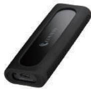
■22mm幅、M-Key/B&M-Key形状のM.2 NVMe規格SSDに対応 ■スリムなアルミボディにアルミ製放熱プレート&熱伝導シートでM.2 SSDの高い発熱を効果的に放熱 ■USB Type-A、Type-C接続両対応、Type-C変換コネクタ付Type-A⇄Type-C USBケーブル付属 ■USB 3.2 Gen2接続対応、最大10Gbps(理論値)の高速転送可能 [1045MB/s] ■筐体を保護するためのシリコンバンパー付属 ※弊社環境での実測値 [Samsung970EVO 250GBにて計測時]。 ※USB 3.2 Gen2は、USB 3.1 Gen2と同仕様の規格となります
