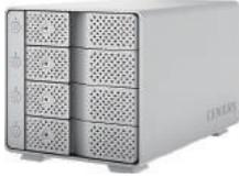
■独立電源スイッチを搭載した3.5インチSATA x4BayのHDD多段ケース ■冷却性に優れた9cm角冷却ファンを搭載した新デザイン&アルミボディを採用 ■高速なUSB 3.1 Gen2インターフェイスを採用(562.5MB/s)※ ■別売りの変換アダプター「裸族のインナー(CRIN2535)」(P.33)とSSDの組み合わせで高速動作が可能 ■盗難防止用ケンジントロックに対応し、市販のセキュリティーワイヤーを接続できます
