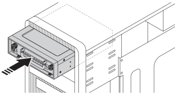
3. 付属のベイ固定用ネジを使用してPCに固定します(左右4箇所)。
