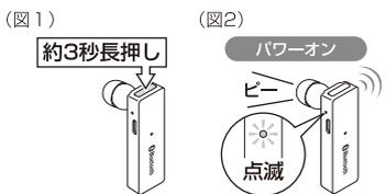
**2** 本製品の電源をオフにするには、本体の設定スイッチを約3秒長押しします。(図1) イヤホンから「ピー」と音が鳴り、動作ランプが消灯すればパワーオフとなります。(図2)
