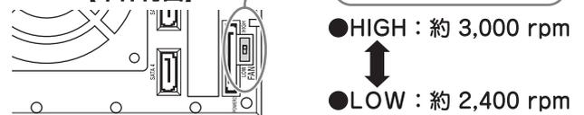
※本製品に搭載されている冷却ファンは「排気ファン」になります。PCへの組み込みの際は、エアフローを十分考慮した上で設置を行ってください。また、発熱量の高いHDDを搭載する場合や、やむを得ずエアフローが十分に確保できないケースにて使用する場合は、ファン回転数を「HIGH」にして使用することを推奨します。
