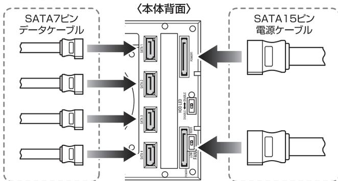
**注意** 本製品の電源供給は、SATA 15ピン電源コネクタのみとなります。4ピン電源コネクタは使用できません。各ケーブルを接続する際は、PCの電源がオフになっていることを必ず確認し、コネクタの向きに注意して接続してください。
