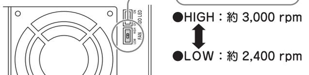
※本製品に搭載されている冷却ファンは「排気ファン」になります。PCへの組み込みの際は、エアフローを十分考慮した上で設置を行ってください。また、発熱量の高いHDDを搭載する場合や、やむを得ずエアフローが十分に確保できないケースにて使用する場合は、ファン回転数を「HIGH」にして使用することを推奨します。
