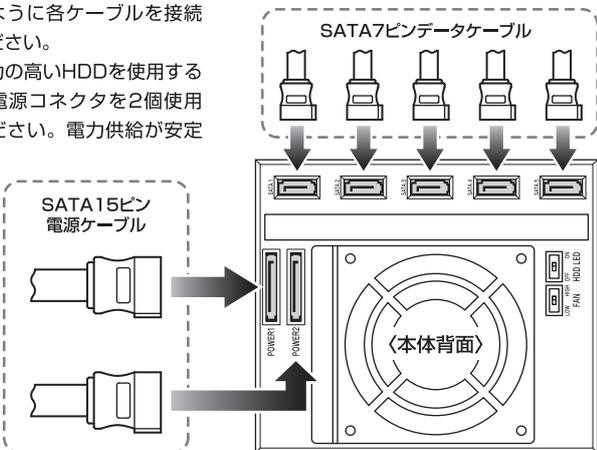
**注意** 本製品の電源供給は、SATA 15ピン電源コネクタのみとなります。4ピン電源コネクタは使用できません。各ケーブルを接続する際は、PCの電源がオフになっていることを必ず確認し、コネクタの向きに注意して接続してください。
