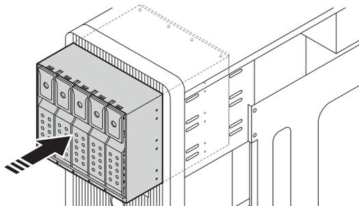
2. 本製品側面のケース取付けネジ穴をPCケースのネジ穴スリットに合わせ、付属のベイ固定用ネジ(8本)で本製品を固定します。
