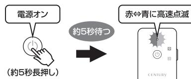
5 Bluetooth機器との接続が確立すると、パワー/ステータスLEDが長間隔で青色に1回点滅するようになります。
