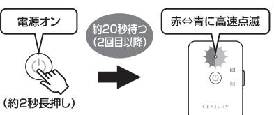
5 Bluetooth機器との接続が確立すると、パワー/ステータスLEDが一定間隔で青色に点滅するようになります。
