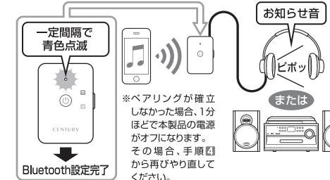
6 Bluetooth設定画面に本製品の型番「CBTTR-AV2」が表示されますので、それを選択すると接続が開始され、自動的に完了します。
