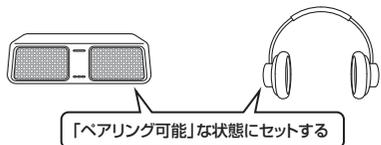
**4** 本製品の電源がオンの状態から約5秒後にパワー/ステータスLEDが赤⇒青に高速点滅し、ペアリングモードになります。
