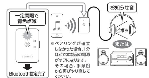
**6** Bluetooth設定画面に本製品の型番「CBTTR-AV2」が表示されますので、それを選択すると接続が開始され、自動的に完了します。
