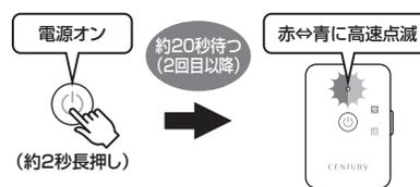
**5** Bluetooth機器との接続が確立すると、パワー/ステータスLEDが一定間隔で青色に点滅するようになります。また、オーディオ機器を接続している場合、オーディオ機器からペアリング確立時のお知らせ音が鳴ります。
