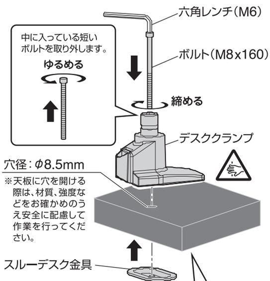
穴径:  $\phi 8.5\text{mm}$
