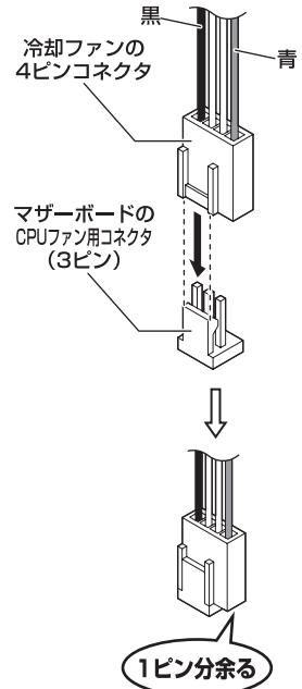
コネクタの向きを間違えて接続すると、本製品およびマザーボードが確実に破損します。
