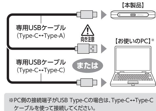
※PC側の接続端子がUSB Type-Cの場合は、Type-C↔Type-Cケーブルを使って接続してください。
