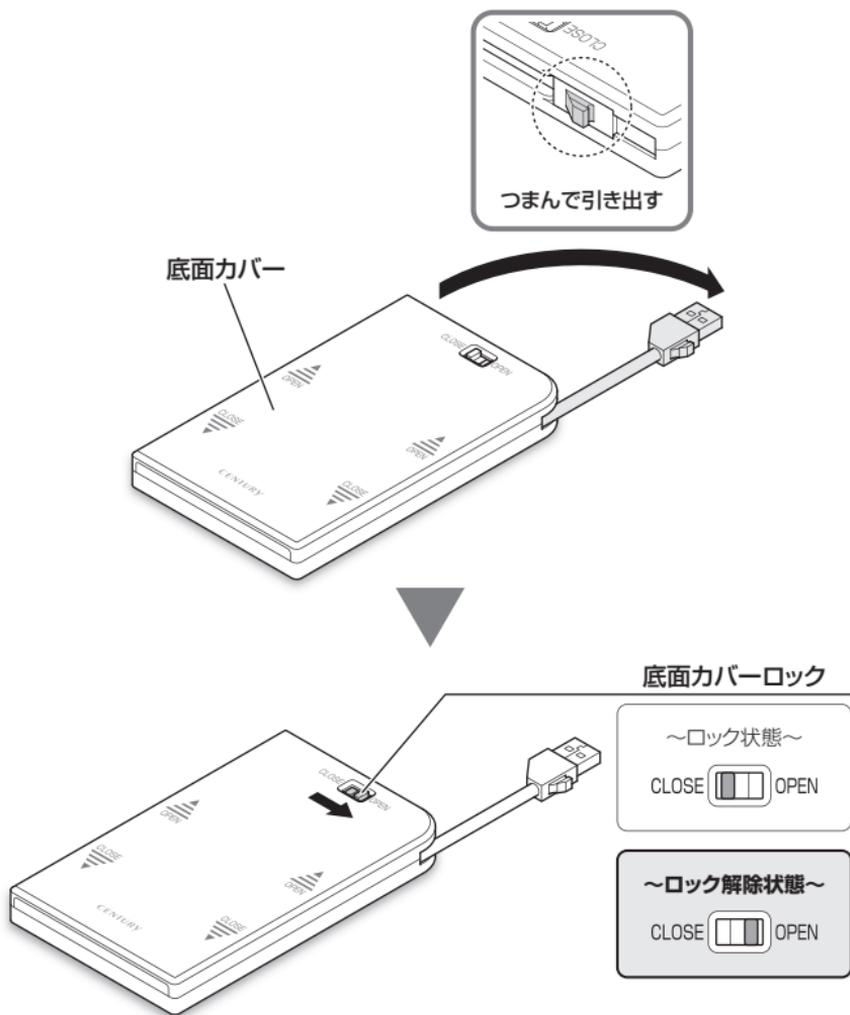
②底面カバーを「OPEN」の方向にスライドして取り外します。
