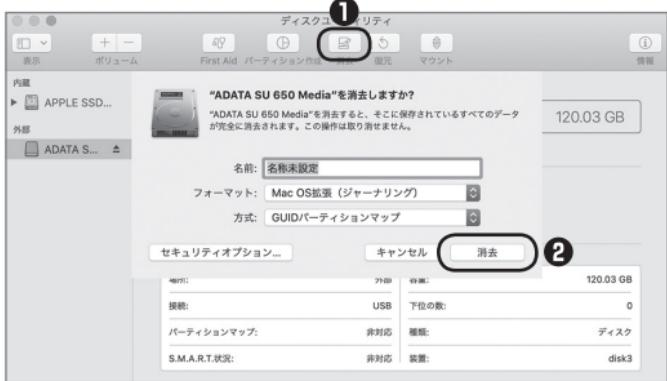
①ウインドウ上部にある「消去」ボタンをクリックすると、シートダイアログが表示されますので設定を確認します。
