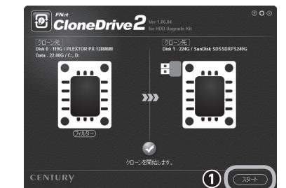
左側がコピー元のドライブ(システムドライブ)、右側がコピー先のドライブになります。
