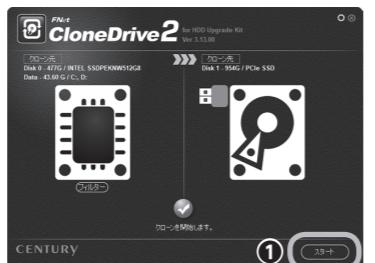
左側がコピー元のドライブ（システムドライブ）、右側がコピー先のドライブになります。
