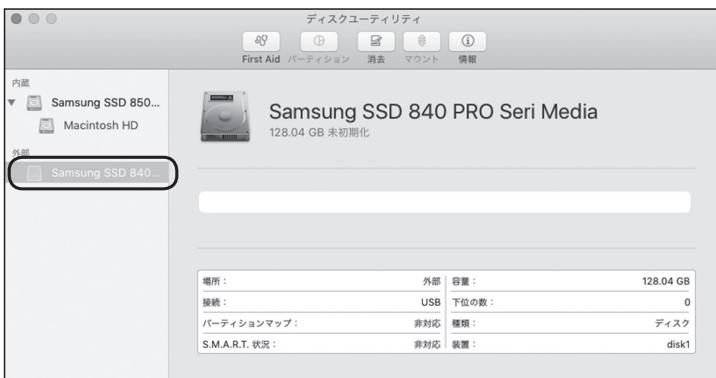
ウインドウ左側「外部」の下に接続されているディスクが表示されますので、フォーマットするディスクを選択します。
