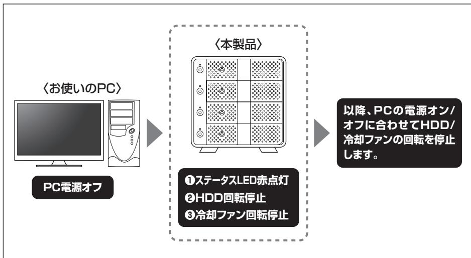
本機能はPCからの信号を感じてHDD/冷却ファンの回転を制御するため、常時3W程度の電力を消費します。
