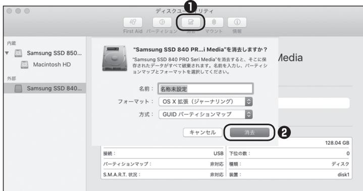
①ウインドウ上部にある「消去」ボタンをクリックすると、シートダイアログが表示されますので設定を確認します。
