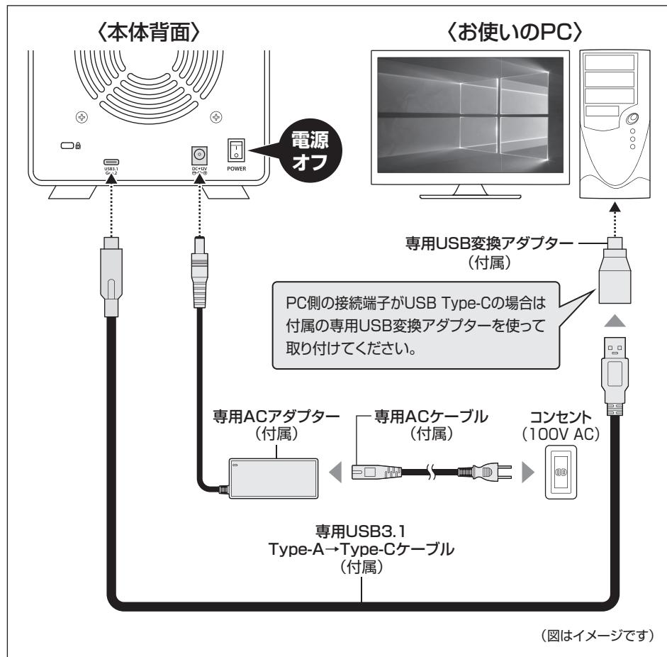
※PCと接続後、P.30「電源の投入方法」をご確認のうえ、電源の投入を行ってください。
