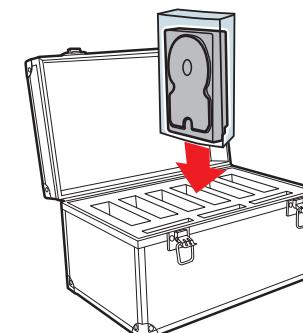
HDDを収納する際は静電防止袋に入れた状態で収納して下さい。
