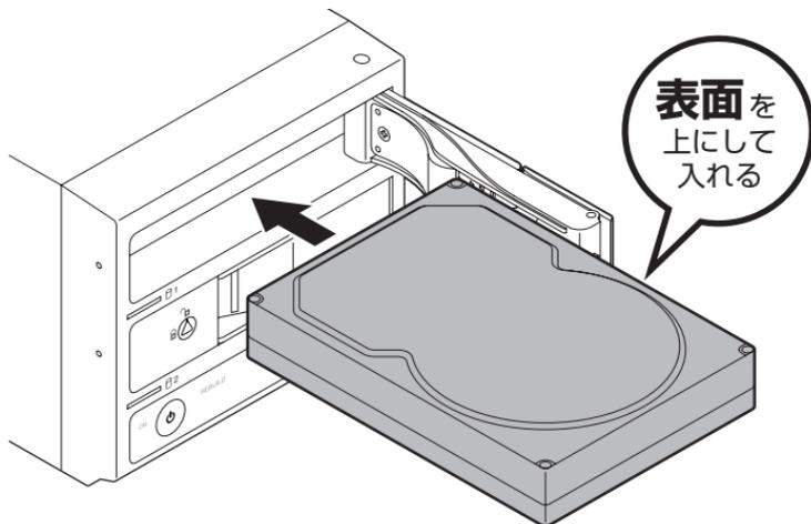
5. HDDがフロントドア内側の金属バネより奥に差し込まれていることを確認したら、フロントドアを閉めます。
