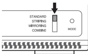
電源がOFFの状態で、モード切り替えスイッチを設定したいモードの位置に合わせます。
