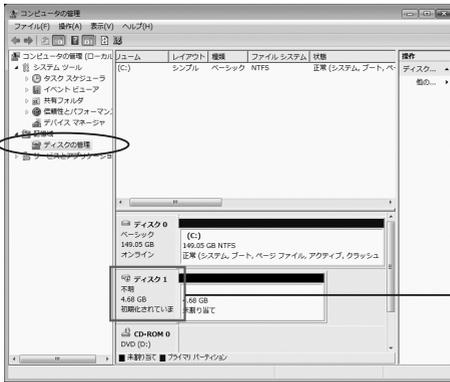
【コンピュータの管理】の【ディスクの管理】を選択すると、接続したディスクが【初期化されていません】と表示されています。そこを右クリックして表示されるポップアップメニューから【ディスクの初期化】を選択します。
