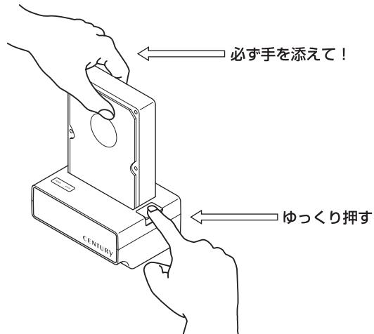
2 : ボタンを押すと、HDD がせり出しますのでゆっくりと垂直に HDD を取り外します。
