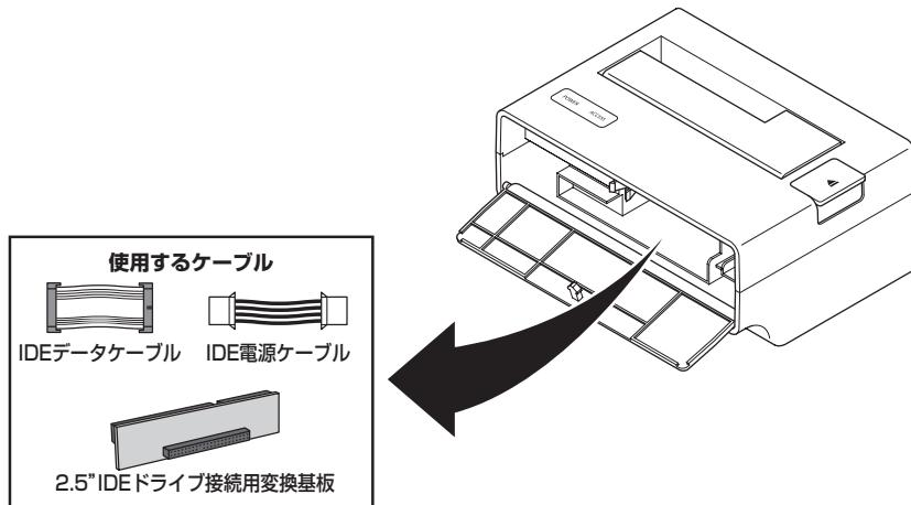
2：本体 IDE 接続コネクタの保護カバーを取り外し、IDE データケーブルと IDE 電源ケーブルを図のように差し込みます。
