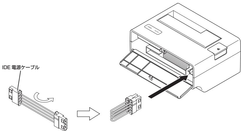
3 : 2.5" IDE ドライブ接続用変換基板を収納します。
