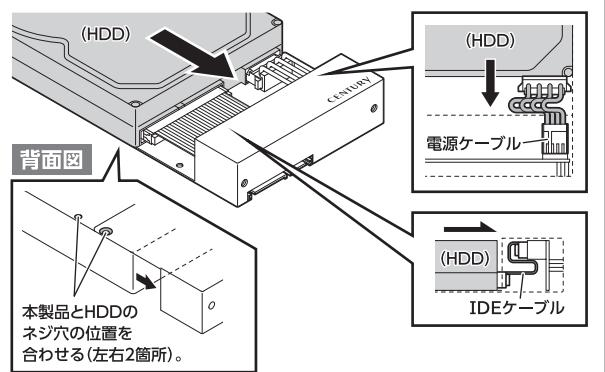
4 専用3.5インチHDD固定用ネジ(付属)を使用して、本製品とHDDをネジ止めします。
