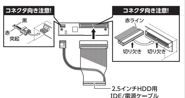
2 HDDに2.5インチHDD用IDE/電源ケーブルの片側を取り付けます。
