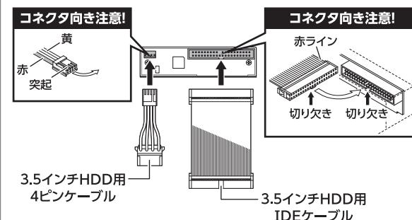
2 HDDに3.5インチHDD用IDEケーブルと、3.5インチHDD用4ピン電源ケーブルの片側をそれぞれ取り付けます。
