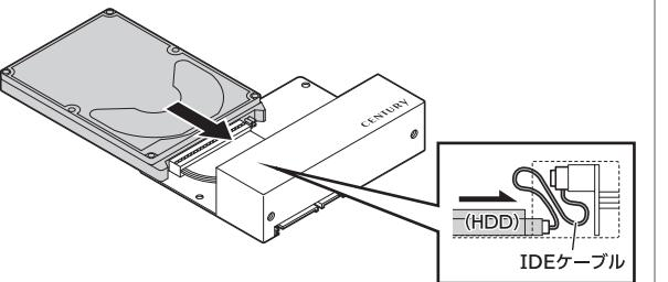
4 専用2.5インチHDD固定用ネジ(付属)を使用して、本製品とHDDをネジ止めします。
