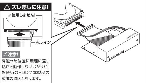
3 接続したケーブル類を折りたたむようにして、本製品とHDDのネジ穴位置を合わせます。
