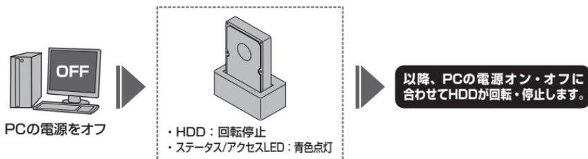
※HDD/SSDの抜き差しを行う際は、必ず主電源を「オフ」にして行ってください。
