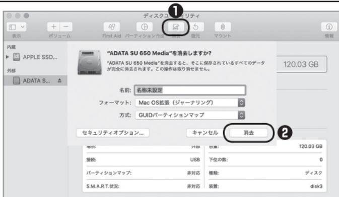
❶ ウィンドウ上部にある「消去」ボタンをクリックすると、シートダイアログが表示されますので設定を確認します。
