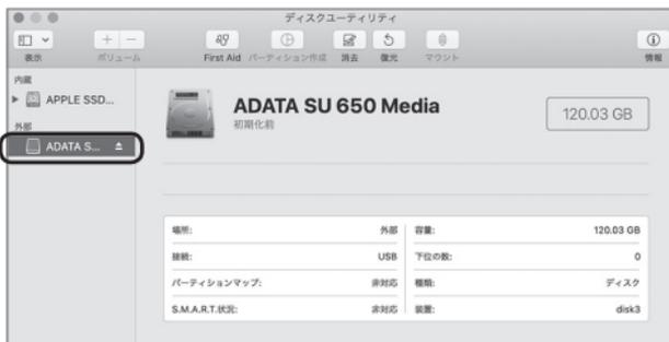
ウィンドウ左側「外部」の下に接続されているディスクが表示されますので、フォーマットするディスクを選択します。
