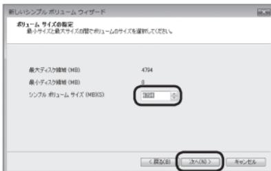
【ボリュームサイズの指定】が表示されます。MB(メガバイト)単位でボリュームサイズを指定します。ここで指定したサイズがパーティションサイズとなりますので、任意の数値を指定してください。特に指定しなければ最大容量で設定されます。設定したら【次へ】をクリックします。
