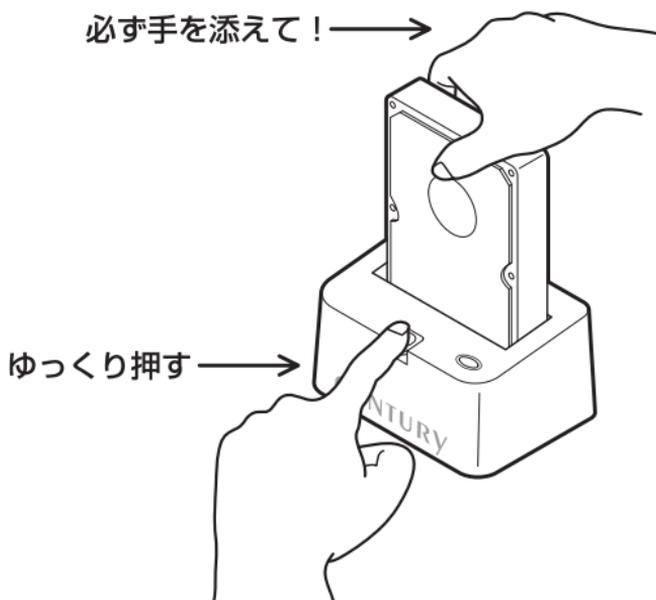
2. ボタンを押すとHDD(またはSSD)がせり出てきますので、ゆっくりと垂直にHDD(またはSSD)を取り外します。
