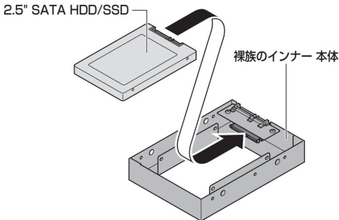
2. 付属のHDD固定用ミリネジで、本体とHDD/SSDを左右から4箇所ネジ止めます。最後に本体を表向きにして完成です。
