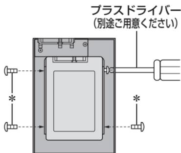
\*HDD/SSD固定用ミリネジ(付属)
