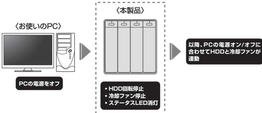
本機能はPCからの信号を感知してHDDの回転を制御するため、常時3W程度の電力を消費します。
