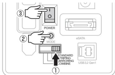
電源がOFFの状態、モード切替スイッチを「STANDARD」の位置に合わせ(①)、モード切替スイッチを押しながら(②)、電源をONにします(③)。
