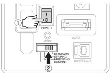
電源をOFFにして(①)モード切替スイッチを希望のモードにセットし(②)、モード変更ボタンを押しながら(③)、電源をONにします(④)。
