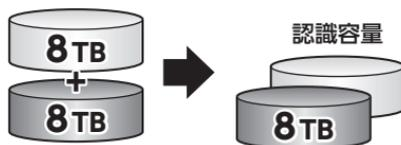
8TBのHDDを2台使用すると8TBのHDD1台のボリュームとして認識される。
