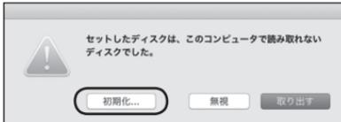
フォーマットされていないディスクを接続すると、メッセージが表示されますので、「初期化...」をクリックすると、ディスクユーティリティが起動します。
