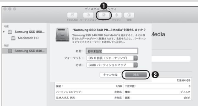
❶ ウィンドウ上部にある「消去」ボタンをクリックすると、シートダイアログが表示されますので設定を確認します。
