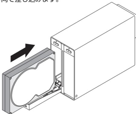
**3.** HDDを差し込んで奥に当たったら(①)、フロントドアを持ち上げて「カチッ」と音が鳴るまで押し込みます(②)。
