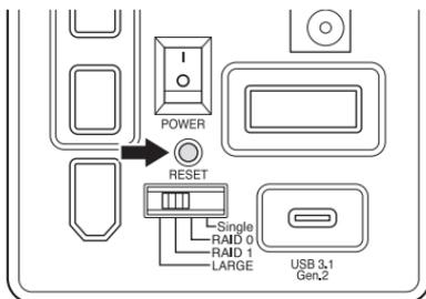
ボールペンの先や細い棒などを使ってモード変更ボタンを約5秒間長押しすると、自動的にPCとの接続が解除、再接続されてモードが変更されます。
