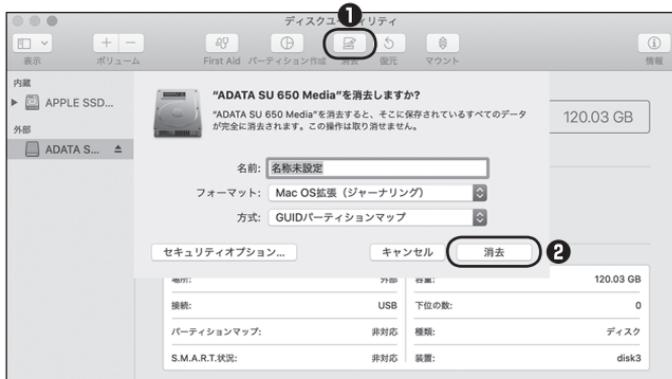
① ウィンドウ上部にある「消去」ボタンをクリックすると、シートダイアログが表示されますので設定を確認します。
