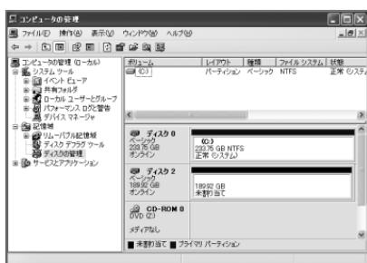
次にパーティションの作成を行います。 「未割り当て」と表示され、斜線になっているディスクがフォーマットされていないディスクですので、「未割り当て」と表示されている部分を「左クリック」で選択し、「右クリック」でメニューを開き、「パーティションの作成(P)…」を選択します。
