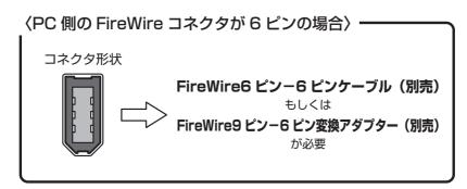
・お手持ちのPC に搭載されている FireWire コネクタが、電源供給されない4ピンタイプの場合は、 別売の FireWire6 ピン -4 ピンケーブルと AC アダプターが必要になります。
