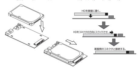
※コネクタのずれ挿しや半挿し状態で通電すると、ディスクや基板が破損します。 間違いなく、奥まで正しい位置に接続されますようお気を付けください。
