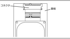
3:組み立てた基板をフレームにネジ止めし、固定します。
