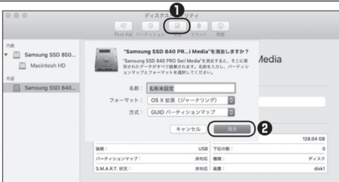
①ウインドウ上部にある「消去」ボタンをクリックすると、シートダイアログが表示されますので設定を確認します。
