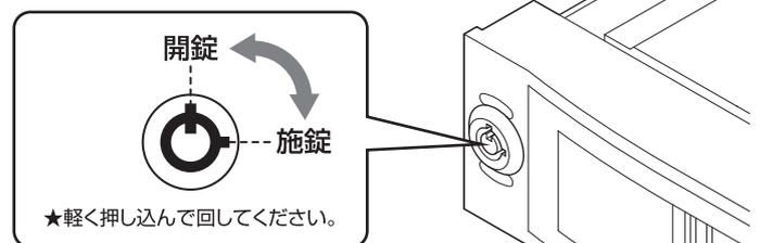
※キーロックとHDDの電源は運動しませんので、HDDの抜き差しを行うときは必ずPCの電源を「オフ」にした状態で行ってください。
