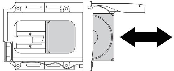
3. HDDを組み込む際にはHDDを最後まで押し込まず、図のように軽くあたったところで止め、ドアを使い「パチン」とロックされるまで押し込んでください。
