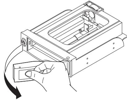
2. HDDの組み込み、または取り出しの際には、図のようにドアを完全に開き、ガイドレールに沿って静かにお取り扱いください。
