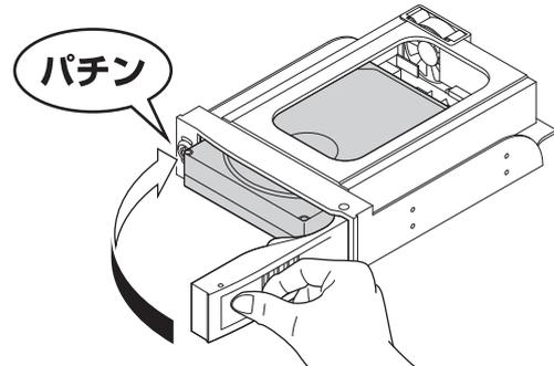
**注意** HDDを組み込む際には、HDDの向きとSATAコネクタの位置に注意してゆっくり差し込んでください。力まかせに押し込むと、破損や故障の原因となります。
