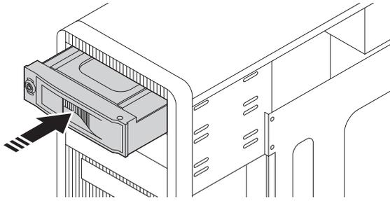
2. PCケースのネジ穴スリットに合わせて、付属のベイ固定用ネジで本製品を固定します。
